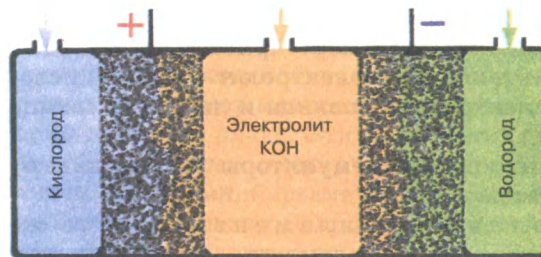
Принципиальная схема гальванического элемента одnorазового действия со щелочным электролитом
