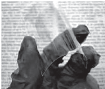
Рис. 2.13. Моноатомный слой графена на гибкой прозрачной подложке. Фото [50]
