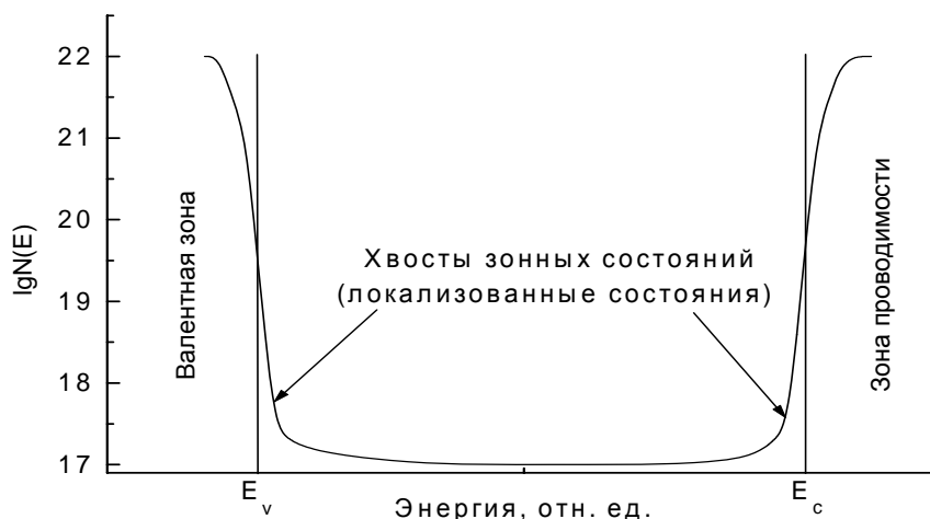
Рис. 2.40. Зонная схема стекла.
