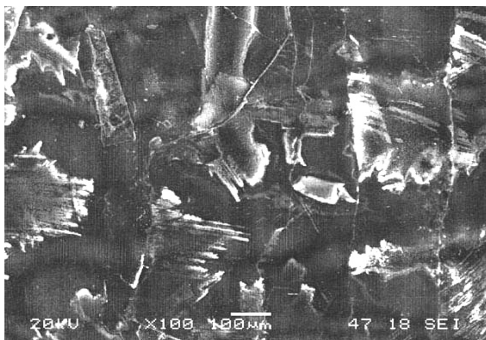
Рис. 6.7. Поверхность необлучённой области (левая часть рисунка a ), промежуточной зоны (правая часть рисунка a ) и облучённого ионами \text{He}^+ участка ( б ) кристалла NaF
