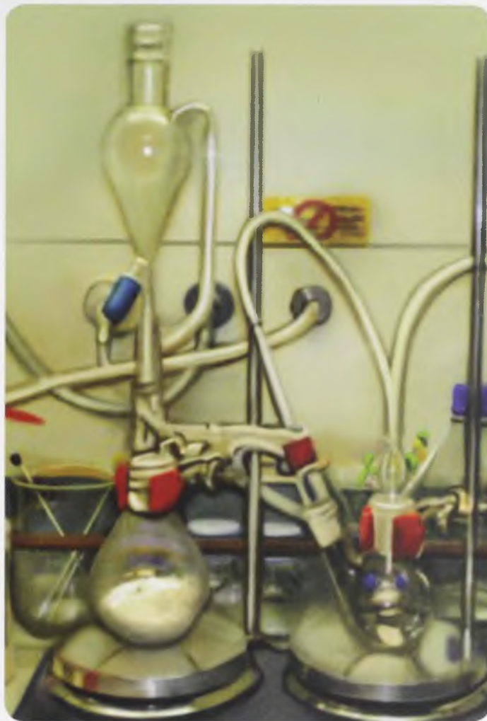
Получение хлорида водорода
