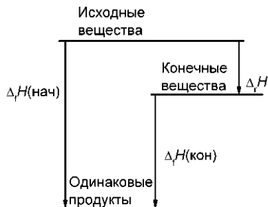
Рис. 2.3. Расчет тепловых эффектов по закону Гесса
