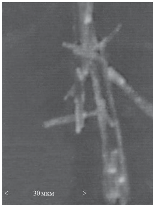
Рис. 4.7. Электронно-микроскопическое изображение кристаллов полугидрата сульфата кальция, выросших в пересыщенном водном растворе, содержащем примесь сульфата церия.
