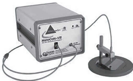
Рис. 3.26. Система для рефлектометрии тонких пленок NanoCalc
